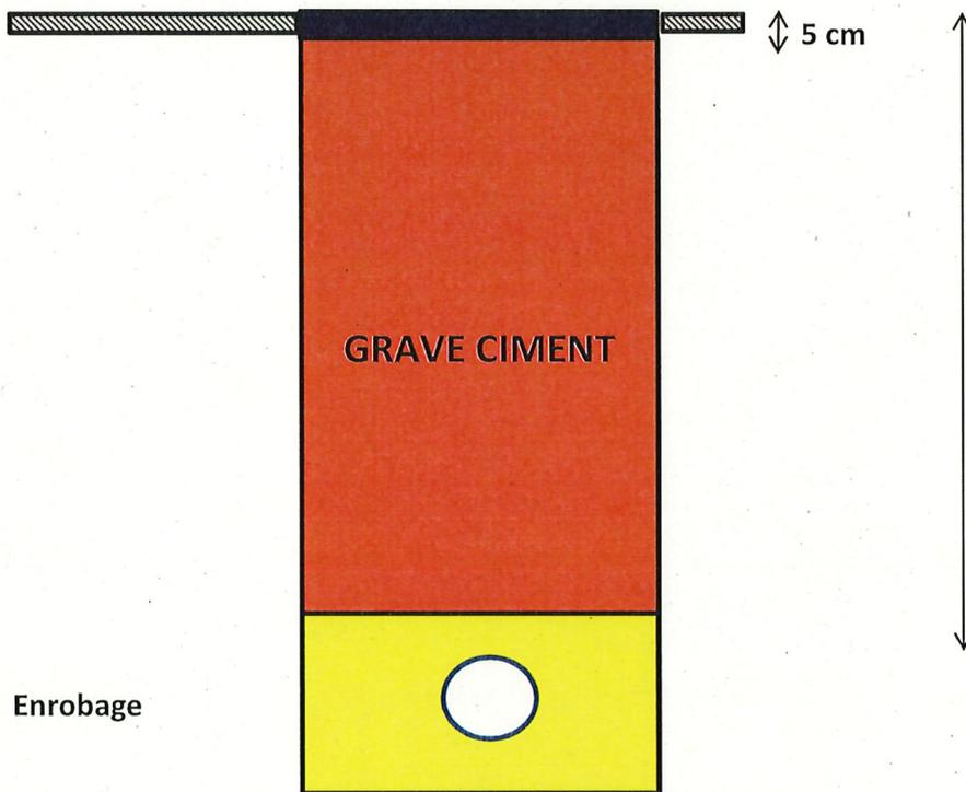
Découpage de chaussée sera exécuté à la scie à disque, bêche mécanique, à la roue tronçonneuse ou à la lame vibrante. Déblais non réutilisés seront évacués en décharge autorisée à la charge de l'entreprise.
